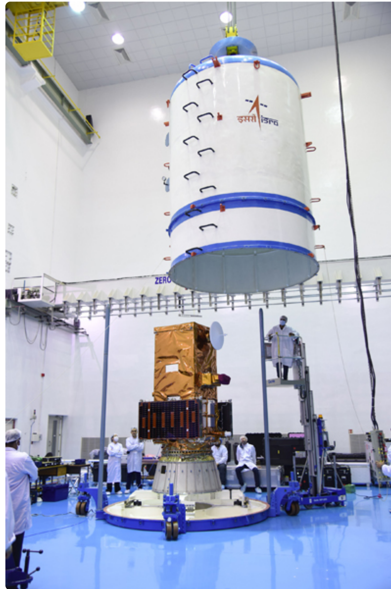
Figura 1 – Amazonia integrado com o sistema de separação e sendo colocado no container.
